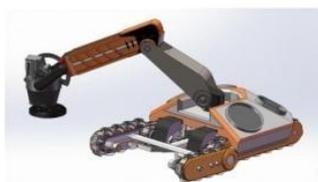
“贴壁巡行”墙面打磨机器人
